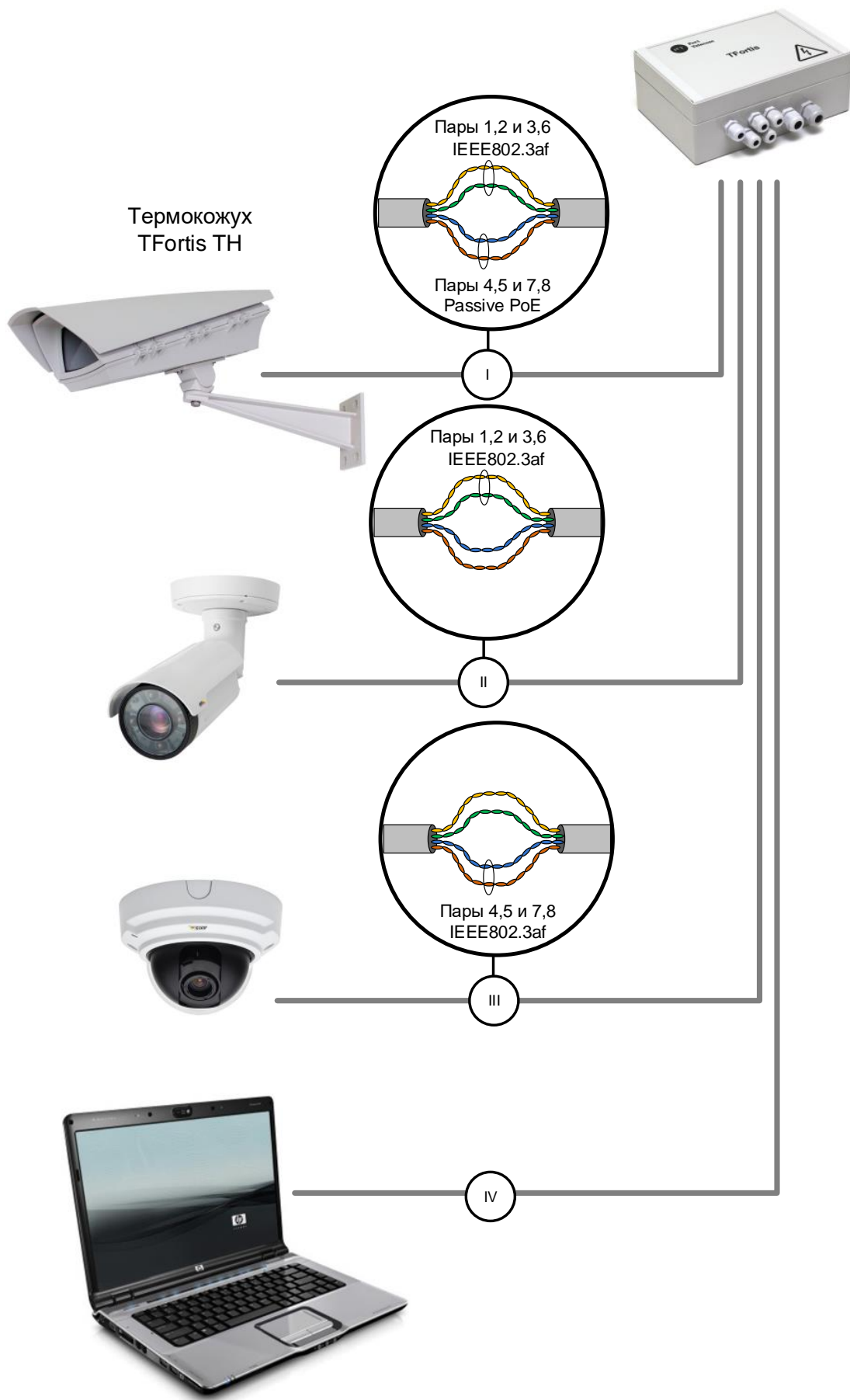
Рисунок 2.3. Схема питания по PoE для разных случаев
