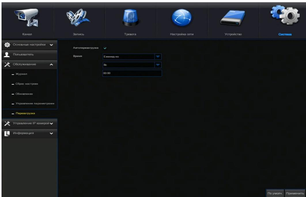
**Автоматическая перезагрузка:** установите флажок для включения.
