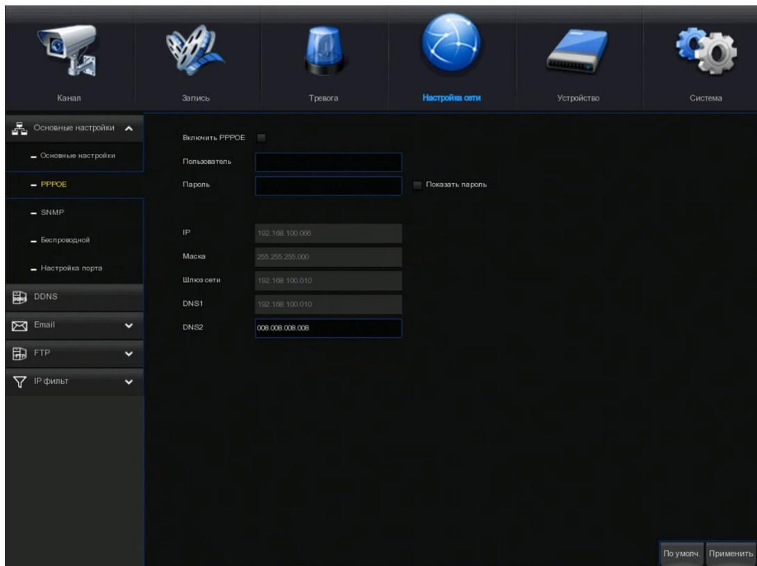
Это расширенный протокол, который позволяет видеорегистратору подключаться к сети более непосредственно через DSL-модем.
