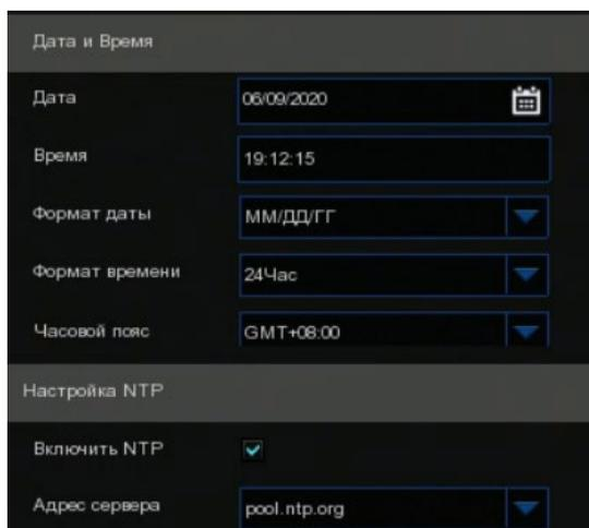
Установите флажок, чтобы включить NTP, и выберите адрес сервера, нажмите кнопку Обновить сейчас, чтобы вручную синхронизировать дату и время.
