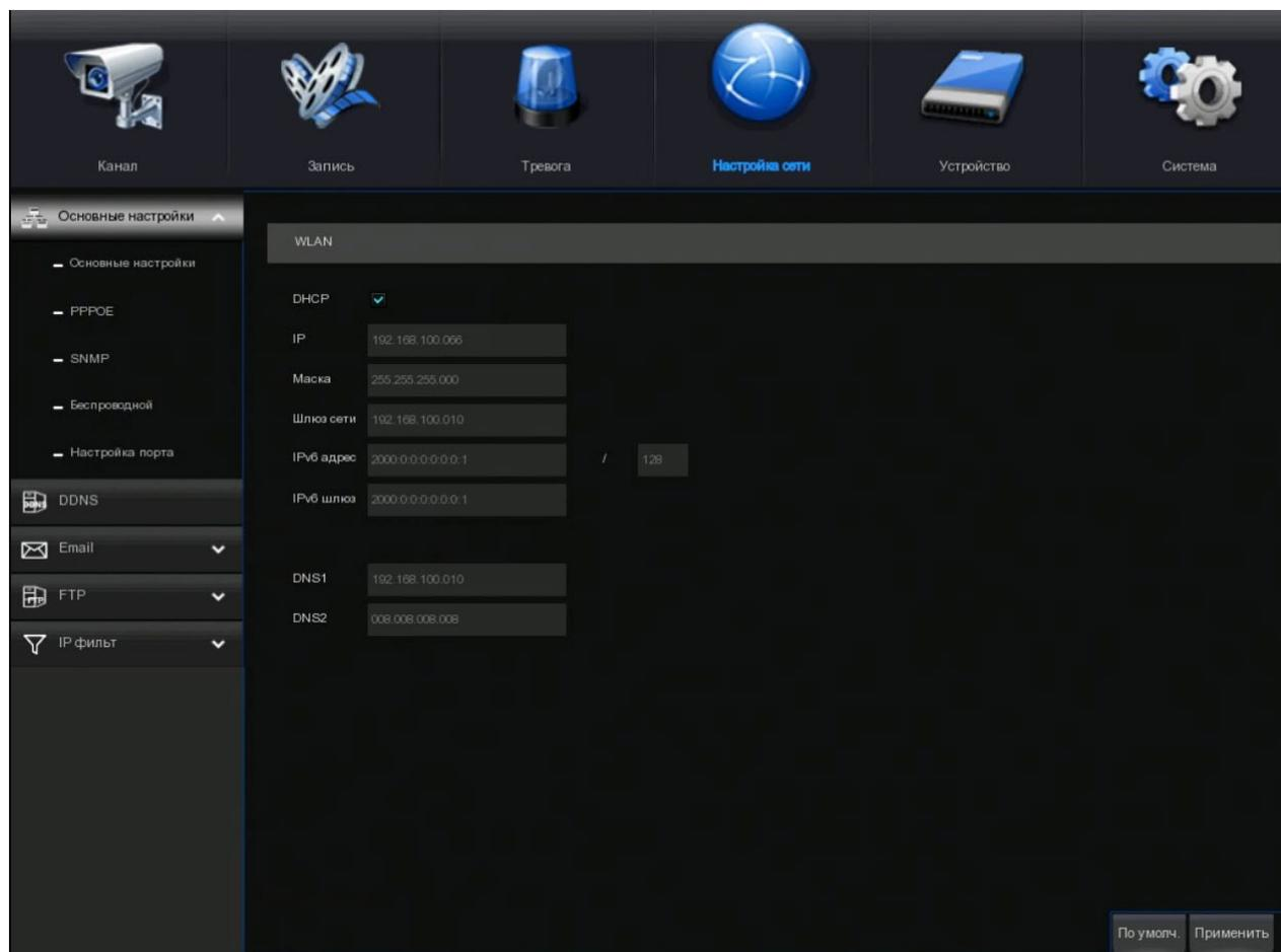
Если вы подключаетесь к маршрутизатору, который позволяет использовать DHCP, пожалуйста, установите флажок DHCP. Маршрутизатор автоматически назначит все сетевые параметры для вашего видеорегистратора. Если только сеть не адресуется вручную ниже параметров:
