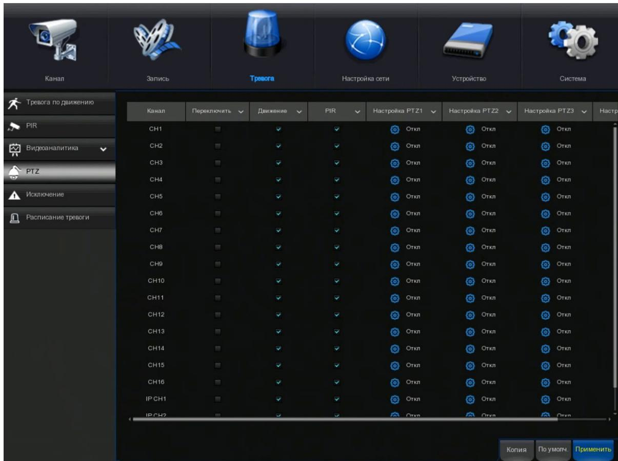
**Переключатель:** включение или отключение функции PTZ-связи.
