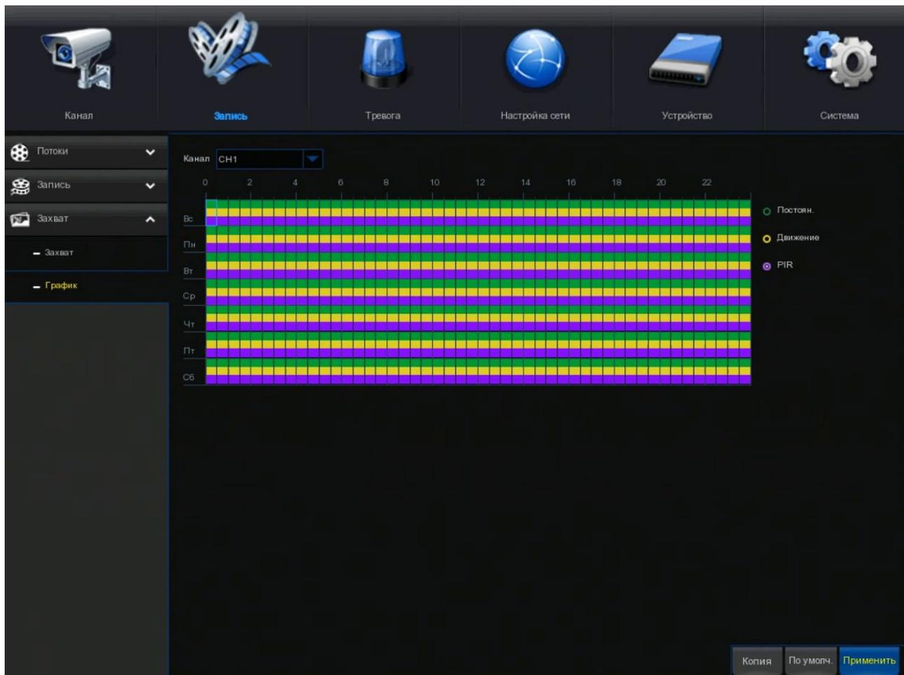
**Канал:** выберите канал, чтобы задать его параметры захвата.
