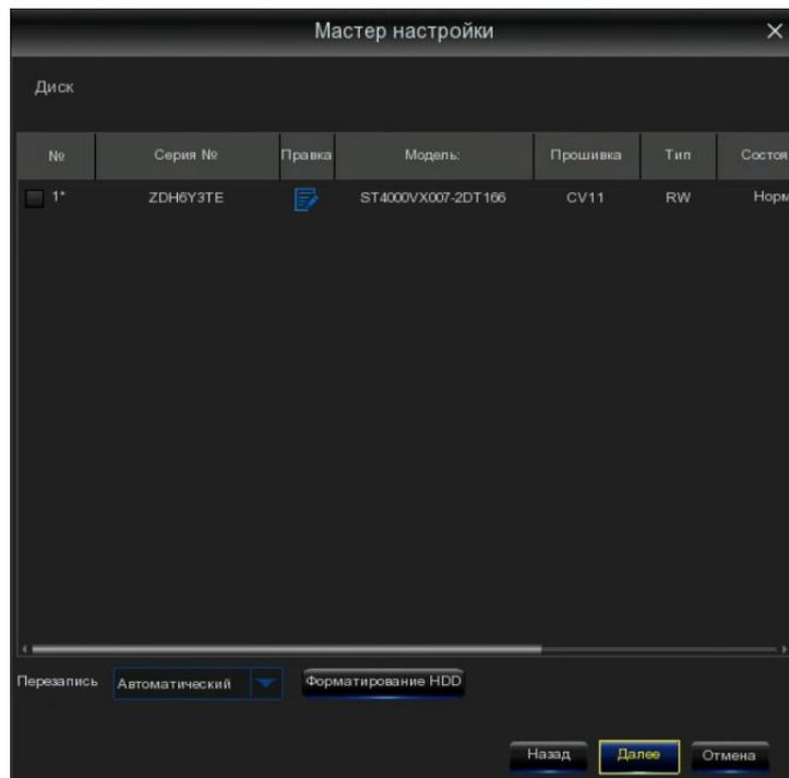
Если жесткий диск установлен в видеорегистратор в первый раз, он должен быть отформатирован. Выберите жесткий диск и нажмите кнопку форматировать жесткий диск, чтобы отформатировать жесткий диск.
