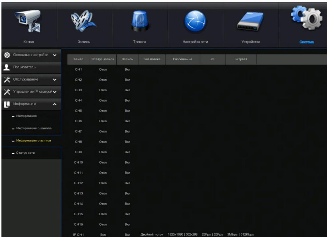
Просмотр информации о записи для каждой подключенной камеры, такой как битрейт, тип потока, разрешение записи и частота кадров (FPS).
