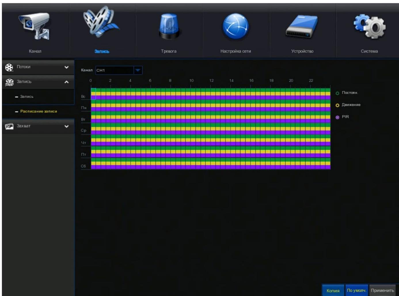
**Канал:** выберите канал, чтобы установить его параметры записи.
