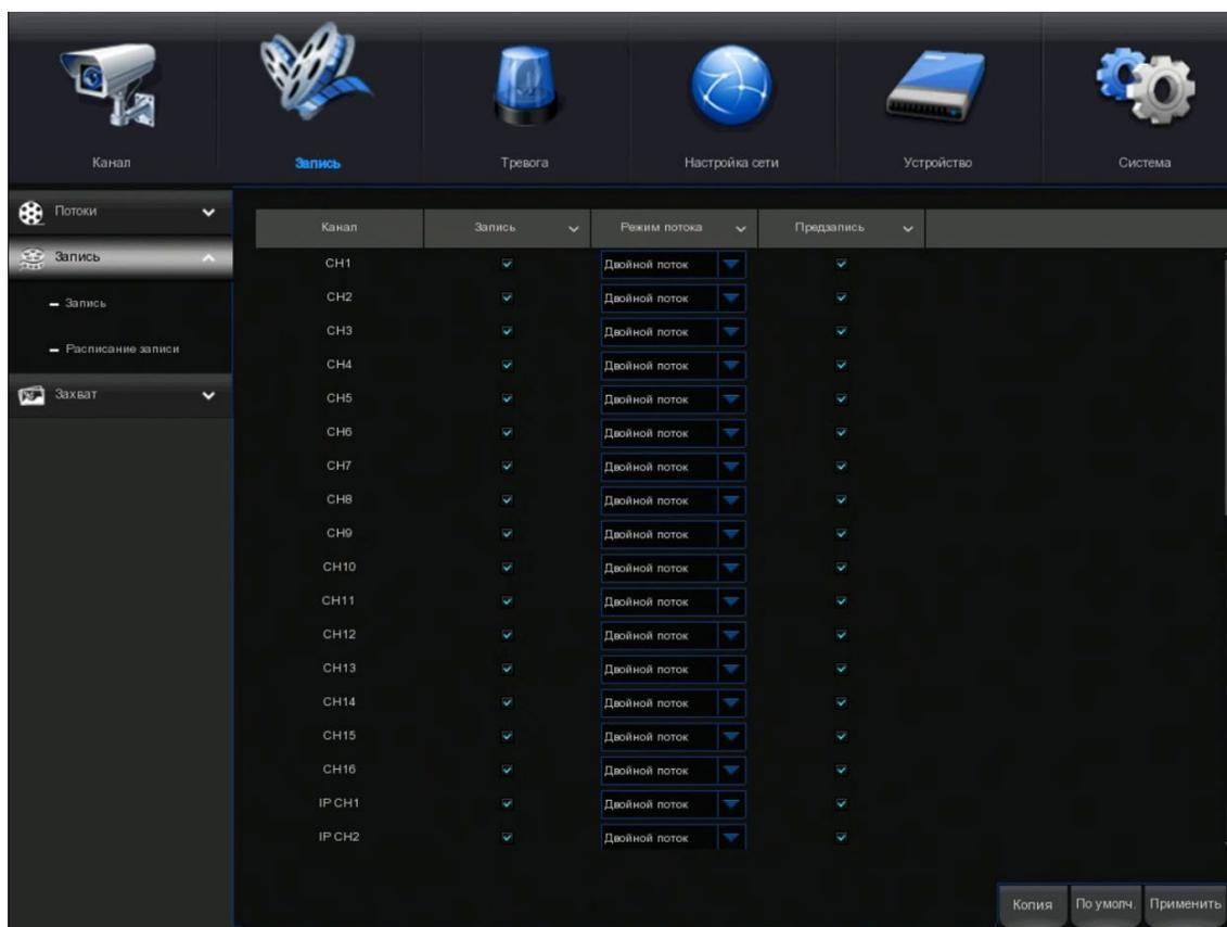
**Переключатель записи:** установите флажок, чтобы включить запись в этом канале.
