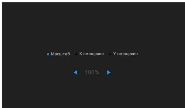
**Масштабирование:** настройка размера отображаемого экрана по шкале.
