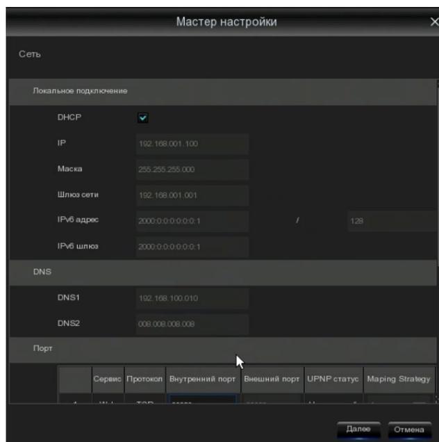
Если вы подключаетесь к маршрутизатору, который позволяет использовать DHCP, пожалуйста, установите флажок DHCP. Маршрутизатор автоматически назначит все сетевые параметры для вашего видеорегистратора. Если только сеть не адресуется вручную ниже параметров:
