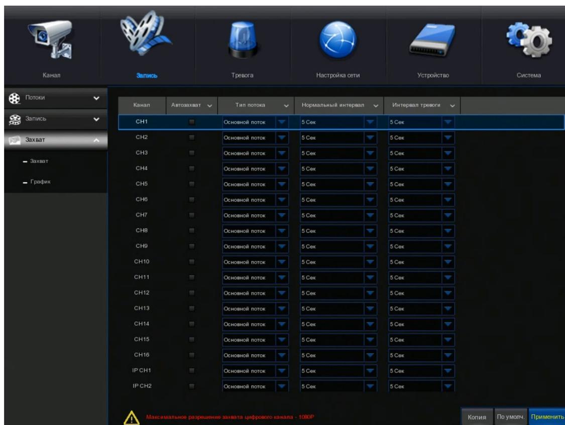
**Включить захват:** включить или отключить автоматический захват на канале.
